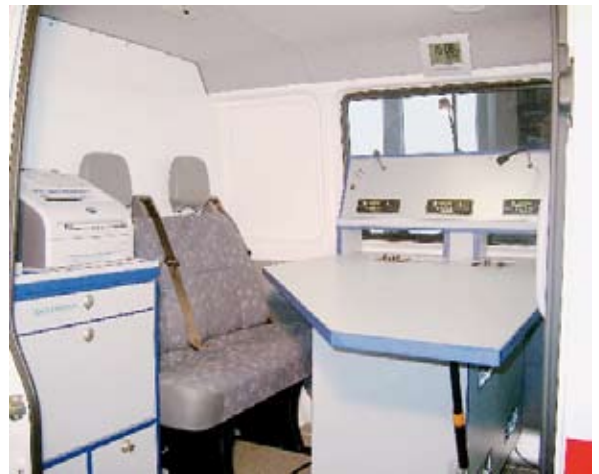
Abb. 2: Im Innern des ELW befindet sich der Funktisch mit drei Arbeitsplätzen
